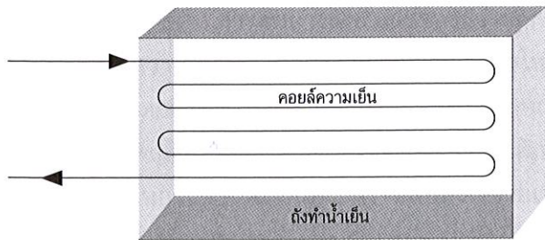
(ก) การวางคอยล์ความเย็นในแนวตามยาวของถังทำน้ำเย็น
